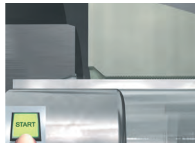
Después de comenzar el proceso, las mordazas sujetan el tubo y el punzón deconformado empieza a moverse hacia adelante
