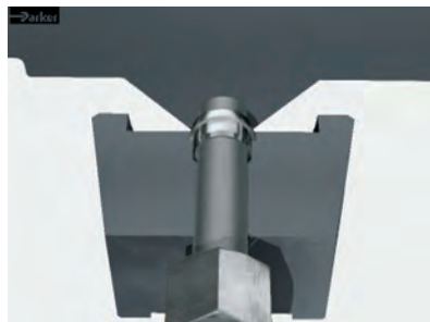
Se inserta el tubo en las herramientas hasta que toca firmemente el tope en el extremo
