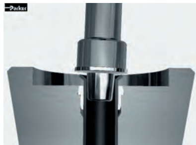
Tan pronto como la superficie de trabajo plana del punzón hace contacto con el extremo del tubo, comienza el proceso de embridado
